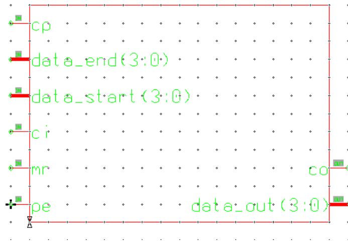
Gambar 6. Blok diagram pencacah yang diinginkan
